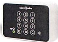
Il lettore LBR2803 è un dispositivo che utilizza la tecnologia RFID per la lettura dei dati identificativi memorizzati all'interno di tessere personali. Viene utilizzato in sistemi di controllo degli accessi o di rilevazione delle presenze, in abbinamento con CCN (controllore di teste ed attuatori).
